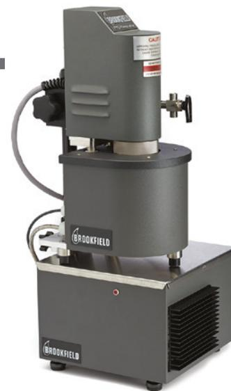
**Вариант термостата с управлением по обратной связи PID**
