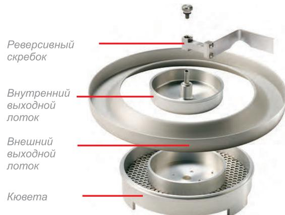
Внешний и внутренний выходные лотки со скрепкой для приготовления образца в кювете
