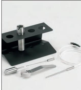
В число остальных поставляемых компонентов входят держатель камеры для пробы, изолирующая крышка, соединительная штанга, стяжная гайка и один из вариантов шпинделя SC4.
