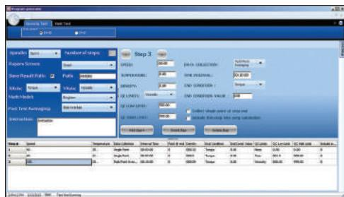
Программное обеспечение PG Flash позволяет пользователям создавать повторяемые собственные испытания с помощью всех встроенных функций на приборе DV2T, а также добавлять несколько строк программы (до 25 шагов). Создайте программу на ПК и загрузите ее на устройство памяти USB. Загрузите программу с устройства памяти USB на прибор DV2T.
