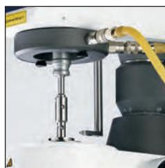
Дополнительное устройство охлаждения KE необходимо для охлаждения подшипников вискозиметра при испытаниях при температуре выше 70°C.
