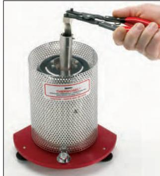
Инструмент для извлечения позволяет обращаться с камерой для пробы просто и безопасно.
