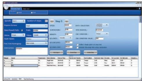
Программное обеспечение PG Flash позволяет создавать повторяемые собственные испытания с помощью всех встроенных функций на приборе DV3T, а также добавлять несколько строк программы (до 25 шагов). Создайте программу на ПК и загрузите ее на устройство памяти USB. Загрузите программу с устройства памяти USB на прибор DV3T.
