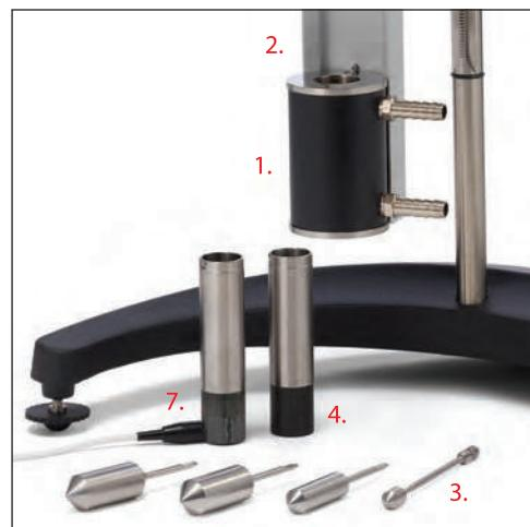
Водяная рубашка позволяет быстро и точно управлять температурой пробы
