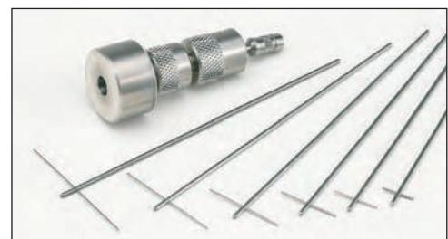
Стойку спирального движения Helipath можно использовать с любой стандартной моделью вискозиметра компании Brookfield. В комплект поставки входит набор из шести Т-образных шпинделей и специальное соединительное устройство.
