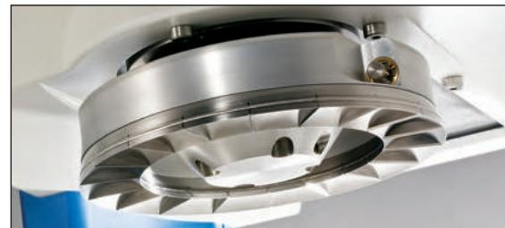
Крупный план лопаточной крышки, используемой для испытания на функцию текучести.
