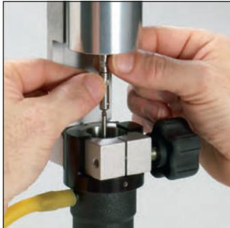
**Быстрое и простое крепление шпинделя**
