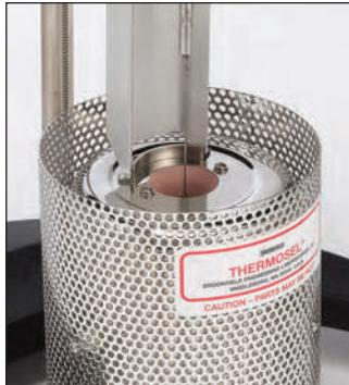
Выравнивающий зажим обеспечивает коаксиальность шпинделя и камеры для пробы.
