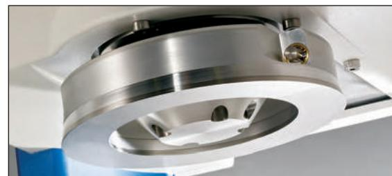
Крупный план крышки измерения пристеночного трения, используемой для испытания на пристеночное трение и на плотность.
