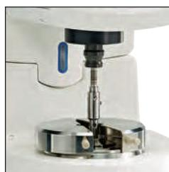
Тепловой экран уменьшает влияние отдачи тепла в окружающую среду. Составляемая из двух частей камера обеспечивает термоизоляцию зоны измерения.
